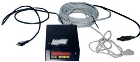
Acquisizione temperature e dati carburazione da sonda lambda
